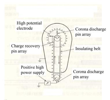
Fig. 13. Schemane rayour of the van de Graan electrostatie generator [4]
